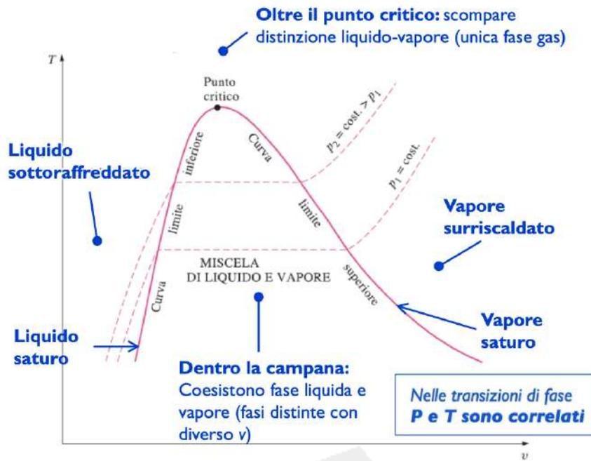
**Dentro** la campana coesistono liquido e vapore → che sono definite solamente da una proprietà (o temperatura o pressione) → grazie a una delle due possiamo identificare il valore dell'altra → sono legate tra loro. **Isoterma** → utilizziamo la regola della leva con i valori nella tabella
